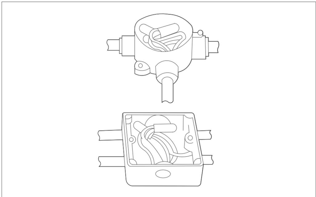
Tất cả các mối nối dây khi lắp đặt phải được đặt trong hộp kỹ thuật, được bảo vệ khỏi tác động của thời tiết và yếu tố con người.
